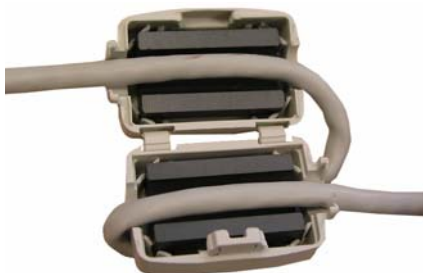
Fig. 5.6 Mise en place du câble dans le noyau ferrite
